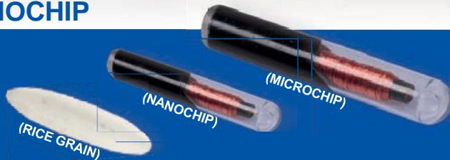
El transpondedor animalltag está incluido en bio vidrio, que se demuestra que no causa rechazo cuando se implanta. La cápsula de bio vidrio está cubierta por una sustancia antimigratoria llamada parilono, que impide el movimiento del transpondedor después de la implantación.
